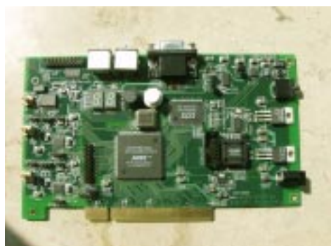
Abb. 52: ACEX-FPGA Testboard und Bildschirmausgabe von “Pac Man”
