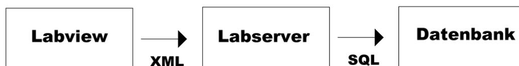
Abbildung 8.3: *Der Weg der Daten-Übertragung: von LabVIEW aus werden die Daten mit Hilfe der XML-VIs in Form von XML-Anweisungen an das Programm Labserver geschickt, das diese Anweisungen in SQL umwandelt und sie an die Datenbank weiterleitet.*
