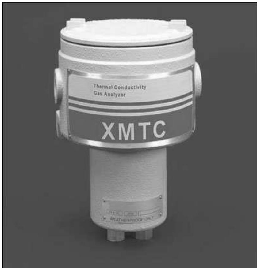
Figure 24: Appareil de mesure de concentration des gaz dans un mélange binaire. Les câbles de transmissions des signaux doivent être passés à travers les valves en plastique sur les deux côtés qu'on devine sur l'image. L'entrée/sortie des gaz se fait par les deux embouts sur le bas de l'instrument.
