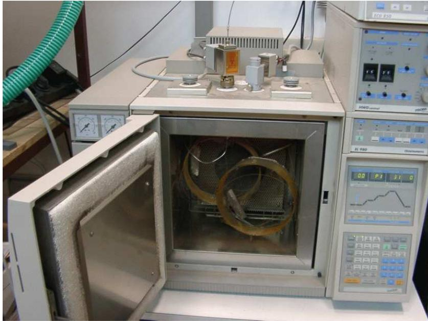
Figure 19: Chromatogramme utilisé pour nos tests. On voit les deux colonnes à l'intérieur. Chacune mène à un détecteur différent, dans notre cas un TCD et un ECD qui n'est pas utilisé. L'injection des gaz se fait à l'aide d'une seringue sur le dessus, une entrée par colonne. Le tableau à droite de l'image permet de contrôler la pression en Helium à l'intérieur, la température de la colonne, le four servant à purifier les colonnes régulièrement.
