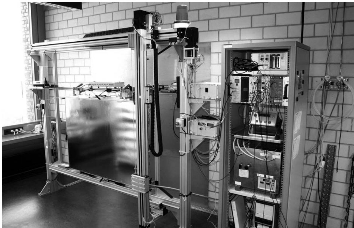
Abbildung 4.1: Ein Foto des Teststandes für ALICE-TRD-Ausleseammern. Die linke Bildhälfte zeigt den Rahmen mit dem zweidimensional beweglichen Wagen. Im Bild befindet sich der Wagen an der rechten oberen Ecke der eingespannten Kammer. Rechts daneben das Rack mit (von oben nach unten) Hochspannungsquellen, Ausleseelektronik, Steuergerät des Sauerstoffsensors, Gassystem und Rechner.
