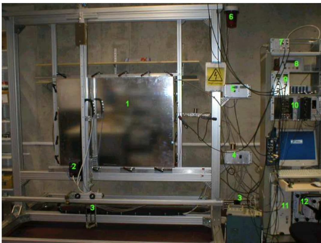
Abbildung 4.4: Messaufbau: 1 TRD Kammer, 2 Röntgenröhre, 3 Schrittmotor, 4 Schrittmotorsteuerung, 5 Hochspannungssteuerbox für die Röntgenröhre, 6 Warnlampe als Indikator für die Hochspannung an der Röntgenröhre, 7 Iseg Geräte, 8 Sauerstoffmessgerät, 9 A 310, 10 Elektronik zur Messung der absoluten Gasverstärkung, 11 Mess-PC, 12 Gassystem.
