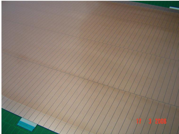
Abbildung 2.4: Segmente bzw. Pads der Kathodenplatte
