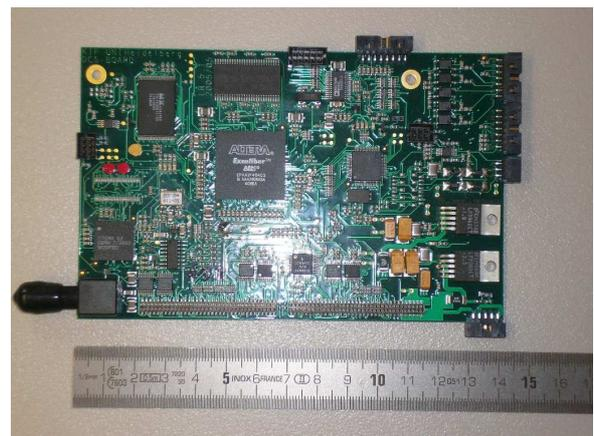
**Abb. A.2:** Optical-Readout-Interface (ORI) zur optischen Signalauslese (links) und Detector-Control-System (DCS) zur Steuerung der Front-End-Elektronik (rechts)
